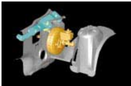
Virtuelle Einbausimulation: Beispiel PKW-Vorbau
